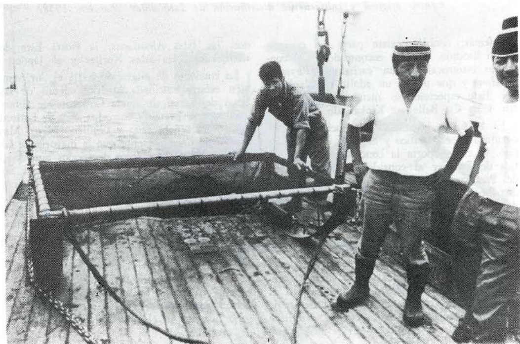
Rastra diseñada por el Dr. del Solar. El marco superior de tubo conteniendo aire y cerrado herméticamente, permite mantener la rastra en una sola posición.
